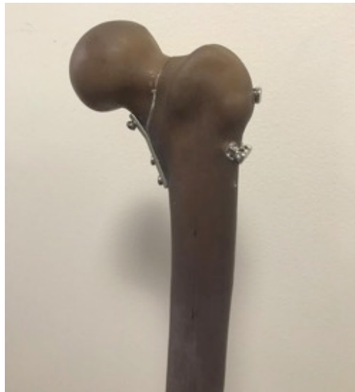
Figura 23: Conjunto osso-implante. Fotografia do corpo de prova com parafusos canulados e placa medial aplicados ao osso sintético.
