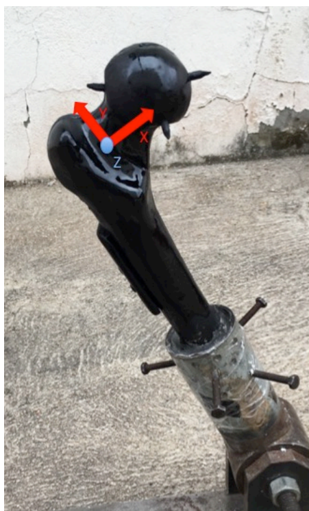
Figura 26. Eixos de avaliação do micromovimento. Fotografia mostrando esquema de eixos utilizados na interpretação dos dados de micromovimento capturados na fase cíclica. Acervo do autor.
