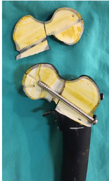
Figura 21. Avaliação da acomodação do osso sintético junto ao implante. Fotografia do osso após ter sido serrado junto a inserção de um dos parafusos canulados.
