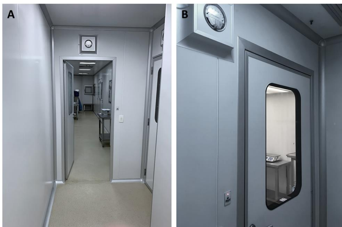
Figura 14. Ambiente do processamento. (A) Corredor interno que dá acesso às salas, ambiente controlado, classificação ISO 7. (B) Sala onde é realizado o processamento do tecido osteocondral, também com gerenciamento do ambiente, classificação ISO5. (Acervo pessoal)
