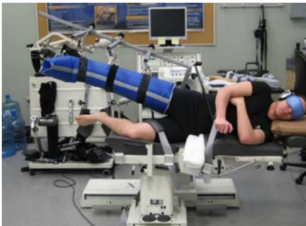
Figura 13- Aparelho desenvolvido para a medição do LPMP do quadril com o sujeito em decúbito lateral. Modificado de (BENIAMINSE et al., 2009).
