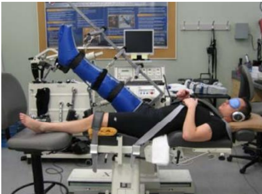
Figura 12- Aparelho desenvolvido para a medição do LPMP do quadril. Modificado de (BENIAMINSE et al., 2009).
