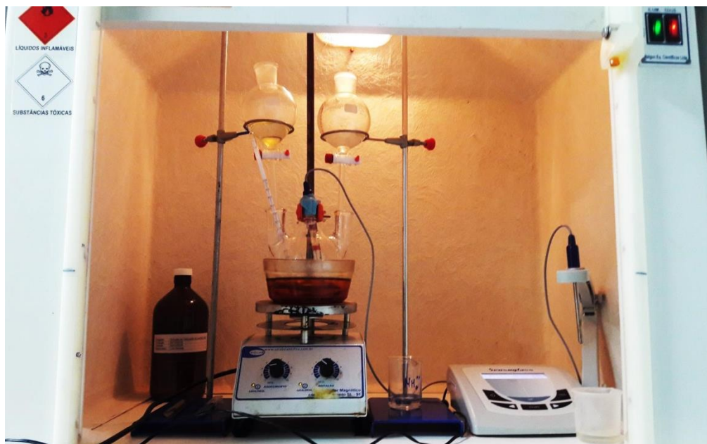
Figura 13. Síntese dos fosfatos de cálcio dopados com íons ferro. Reações contendo 5%, 10%, 15% e 20% em mol de cátions \text{Fe}^{3+} , a partir da COG. Reações realizadas em capela de exaustão, com temperatura, volume e agitação controlados ( arquivo pessoal ).
