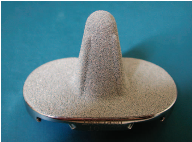
Fig. 3 – Aspecto da porosidade do componente tibial Fig. 3 – Aspect of tibial component porosity
